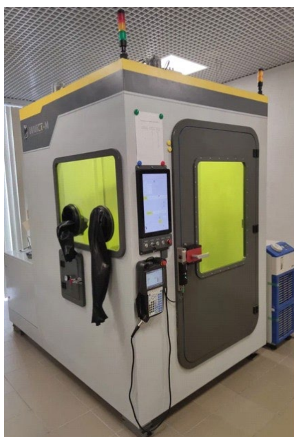
Рис. 3. Используемое оборудование для лазерной порошковой наплавки: а — установка прямого лазерного выращивания ИЛИСТ-М; б — технологический инструмент.
