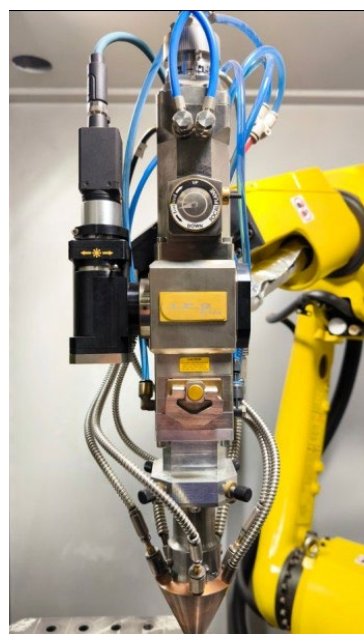
Рис. 3. Используемое оборудование для лазерной порошковой наплавки: а — установка прямого лазерного выращивания ИЛИСТ-М; б — технологический инструмент.
