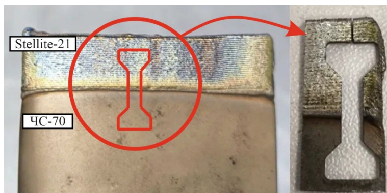
Рис. 6. Схема вырезки образцов для механического испытания. Fig. 6. Sample cutting diagram for mechanical tests.
