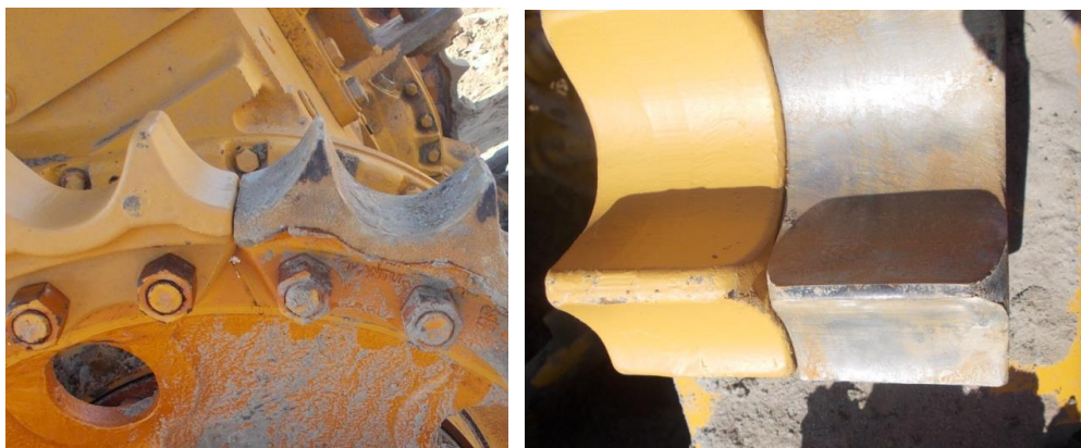
Рис. 5. Пример неисправности, приведшей к полной утрате подвижности техники при разрушении гусеницы вследствие установки при ремонте зубчатого сектора с несоответствующим шагом
