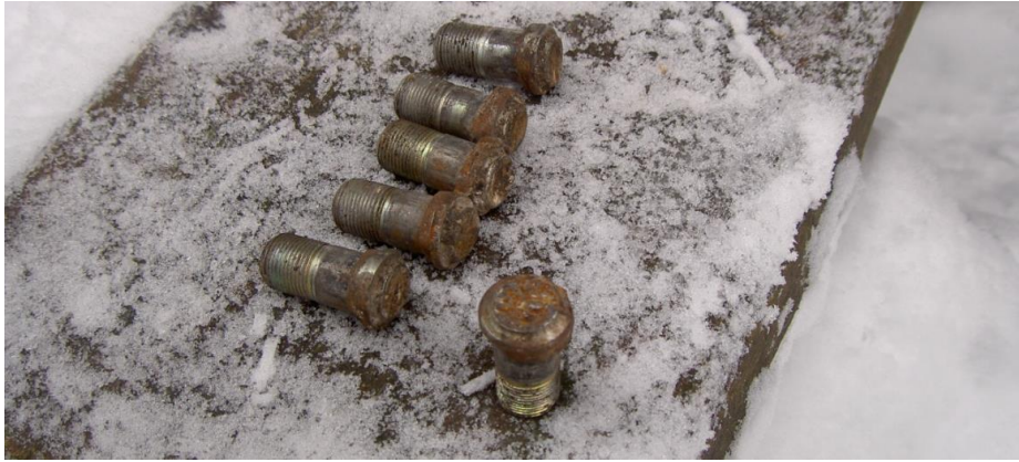
Рис. 2. Пример неисправности, приведшей к полной утрате подвижности техники при одновременном обрыве болтов крепления колеса
