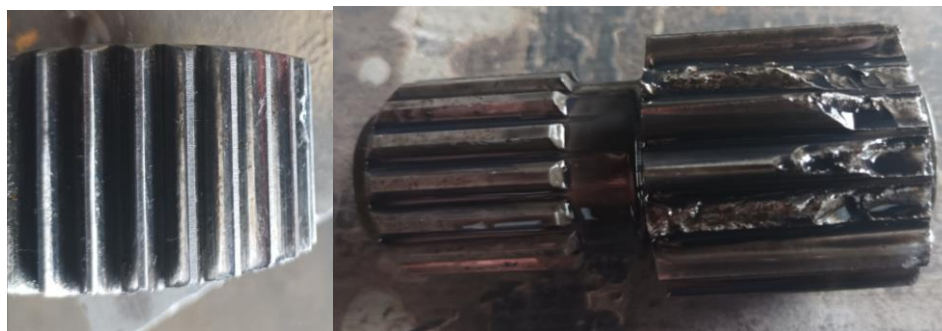
Рис. 10. Начальная и конечная стадии выкрашивания зубьев шестерен
