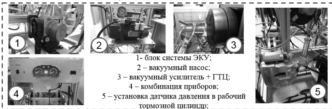
Рис. 2. Внешний вид разработанного стенда (ПАК)
